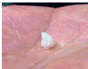
Figuur 1: Milieuvriendelijk waterstof clathraat hydraat op een handpalm dat opwarmt en smelt.
